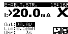
Bild 5.16: Beispiele von Ergebnissen der Messung des Ersatzableitstroms
