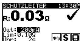
Bild 5.7: Beispiele von Ergebnissen der Schutzleiterwiderstand-Durchgangswiderstandsmessung
