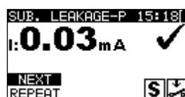
Figura 6.12: VDE Organizer - Fuga sustituta - Pantalla de resultados P
