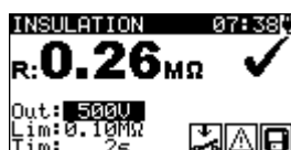
Rysunek 5.9: Przykłady wyników pomiarów rezystancji izolacji
