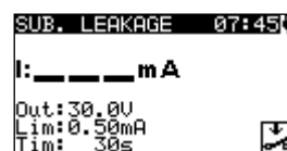
Figura 6.7: VDE Organizer - Schermi di partenza per le perdite sostitutive
