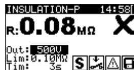
Figure 5.12: Exemple de résultats de mesure de la résistance d'isolement - P
