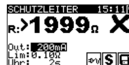
Bild 5.7: Beispiele von Ergebnissen der Schutzleiterwiderstand-Durchgangswiderstandsmessung
