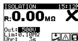
Bild 5.10: Beispiele von Ergebnissen der Isolationswiderstandsmessung
