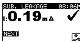
Figura 6.24: Schermata dei risultati delle perdite di sostituzione
