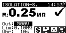
Bild 5.13: Beispiele von Ergebnissen der Isolationswiderstandsmessung-S
