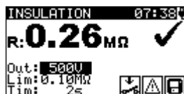
Figura 5.9: Esempi di risultati di misurazione della resistenza di isolamento
