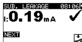
Figura 6.24: Pantalla de resultado de fuga de sustituto
