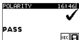
Figur 5.21: Exempel på resultat av polaritetstest
