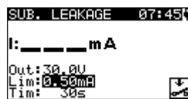
Figure 5.13: Menu de remplacement des fuites
