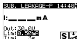
Figura 6.11: VDE Organizer - Fuga de sustitutos - P pantalla de inicio
