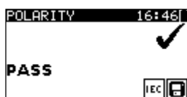
Figura 5.21: Esempi di risultati del test di polarità
