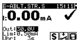
Bild 5.19: Beispiele von Ergebnissen der Messung des Ersatzableitstroms-S
