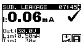
Figura 5.15: Esempio di risultati di misura della corrente di dispersione sostitutiva
