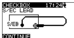
Figura 4.14: Schermata di avvio del controllo del cavo di prova S/EB
