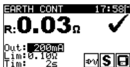
Figura 5.6: Ejemplos de resultados de medición de la resistencia de continuidad de tierra
