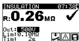
Figura 5.9: Ejemplos de resultados de la medición de la resistencia de aislamiento
