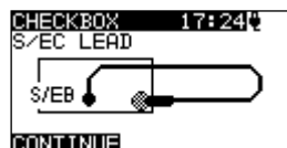
Figur 4.14: Startskärm för kontroll av S/EB-testledning
