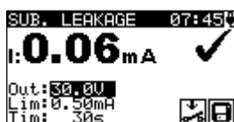
Afbeelding 5.15: Voorbeeld van meetresultaten van vervangende lekstroom
