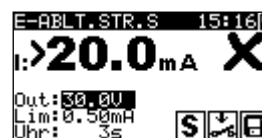
Bild 5.19: Beispiele von Ergebnissen der Messung des Ersatzableitstroms-S
