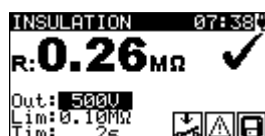
Afbeelding 5.9: Voorbeelden van meetresultaten van isolati weerstand
