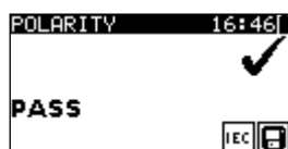
Afbeelding 5.21: Voorbeelden van het resultaat van de polariteitstest
