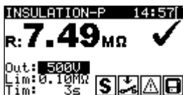
Figure 5.12: Exemple de résultats de mesure de la résistance d'isolement - P
