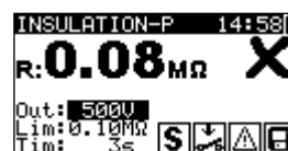
Rysunek 5.12: Przykład wyników pomiaru rezystancji izolacji - P
