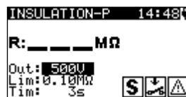
Figura 6.25: Resistencia de aislamiento - Pantalla de arranque P
