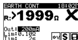
Afbeelding 5.6: Voorbeelden van meetresultaten van de weerstand van de aarddoorgang
