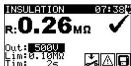
Figure 5.9: Exemples de résultats de mesures de la résistance d'isolement
