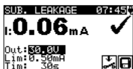
Rysunek 5.15: Przykład wyników pomiaru zastępczego prądu upływu
