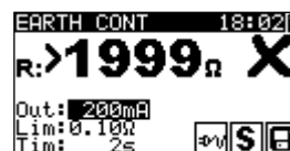
Rysunek 5.6: Przykłady wyników pomiarów rezystancji ciągłości uziemienia
