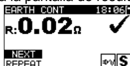
Figura 6.20: Pantalla de resultados de continuidad de tierra
