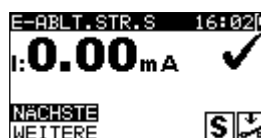
Bild 6.12: VDE-Organisator – Ergebnisbildschirm Ersatzableitstrom-S
