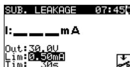
Figure 6.23: Écran de démarrage des fuites de substitution
