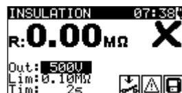
Figure 5.9: Exemples de résultats de mesures de la résistance d'isolement
