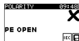
Figure 5.21: Exemples de résultats de tests de polarité
