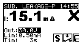
Figura 5.18: Ejemplo de resultados de la medición de la corriente P de fuga de sustituto
