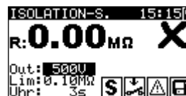
Bild 5.13: Beispiele von Ergebnissen der Isolationswiderstandsmessung-S
