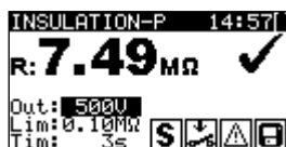
Figura 5.12: Esempio di risultati di misura della resistenza di isolamento - P
