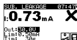
Figura 5.15: Esempio di risultati di misura della corrente di dispersione sostitutiva
