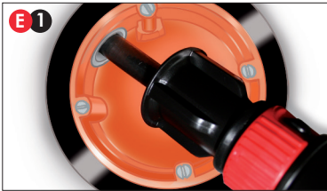
E 1 Steckaufsatz in Rohrende einführen.
