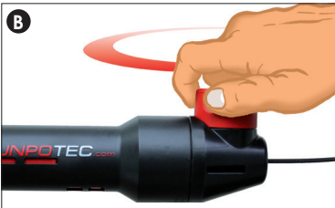
B Draai de klemgreep rechtsonder vast. De spiraal wordt axiaal gefixeerd.
